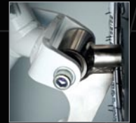
Edelstahldistanzbuchsen Vorderachse (Chassis-höheneinstellung \pm 13 mm)
