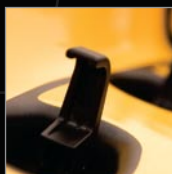
Schnellspanverschlüsse für Achsabdeckung (unverlierbar)
