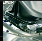
per Hebel verstellbarer, gedämpfter Sitz
